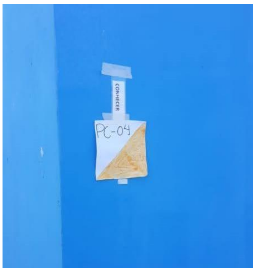
Fotografia 14. PC-04 (posto de controle quatro) montado.
